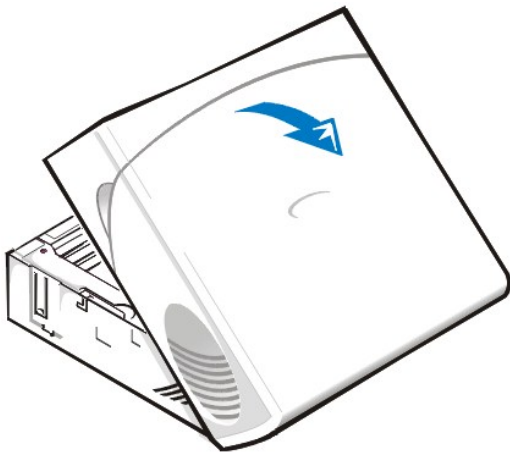
Figura 2. Remoção da tampa dos computadores de perfil baixo e de médio porte
