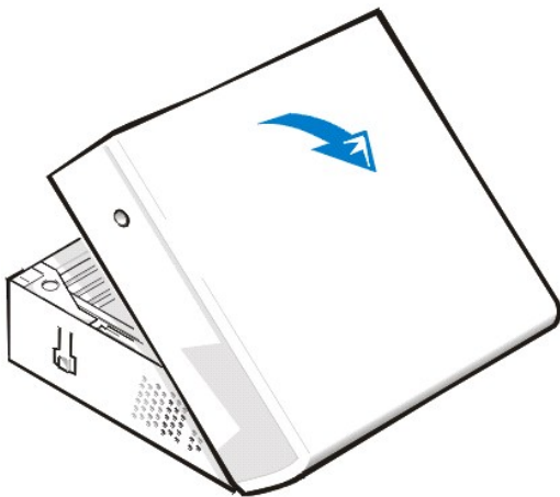
Figura 2. Remoção da tampa dos computadores de perfil baixo e de médio porte
